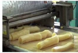
5 選別・定寸（長さを揃える） 不良原料をはね出し、良品のみ長さを切り揃えます。
