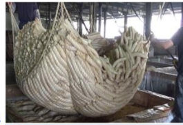
2 塩押し 大根を塩分によって脱水して旨みが凝縮されます。塩押しされることで、大根はソフトな食感になります。
