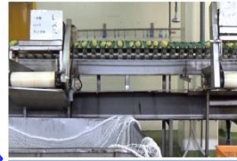
6 重量選別機 重さで分ける機械です。100g刻みで重い・軽い物を4段階に振り分けます。
