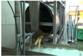
4 洗浄 回転式ドラム洗浄機にて、米糠等を洗い落とします。フロアー（浴）洗浄機にて毛髪や小さなごみを除去します。
